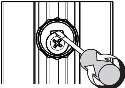
Durch die Excenterbuchse können Bohrtoleranzen ausgeglichen werden.
